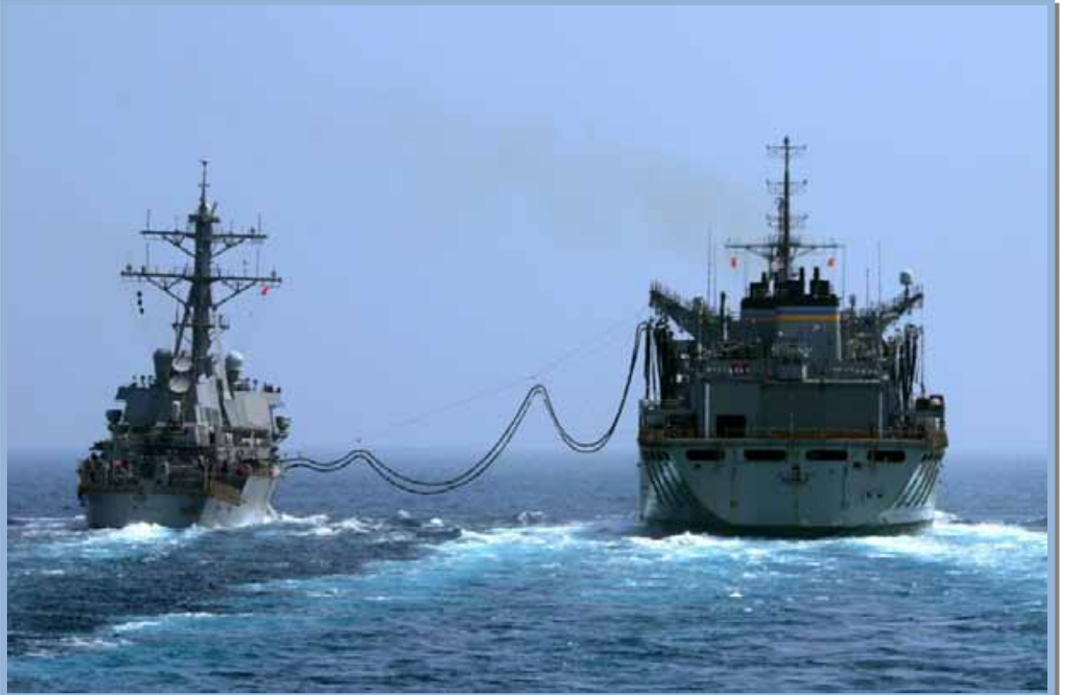
ছবিতে আমেরিকান তেলবাহী জাহাজ USS Supply (ডানদিকে) যুদ্ধজাহাজের (বামদিকে) তেল ভরছে। তেল ভরার সময়ে তেলবাহী জাহাজ ধ্বংস করার কথা ছিল।
